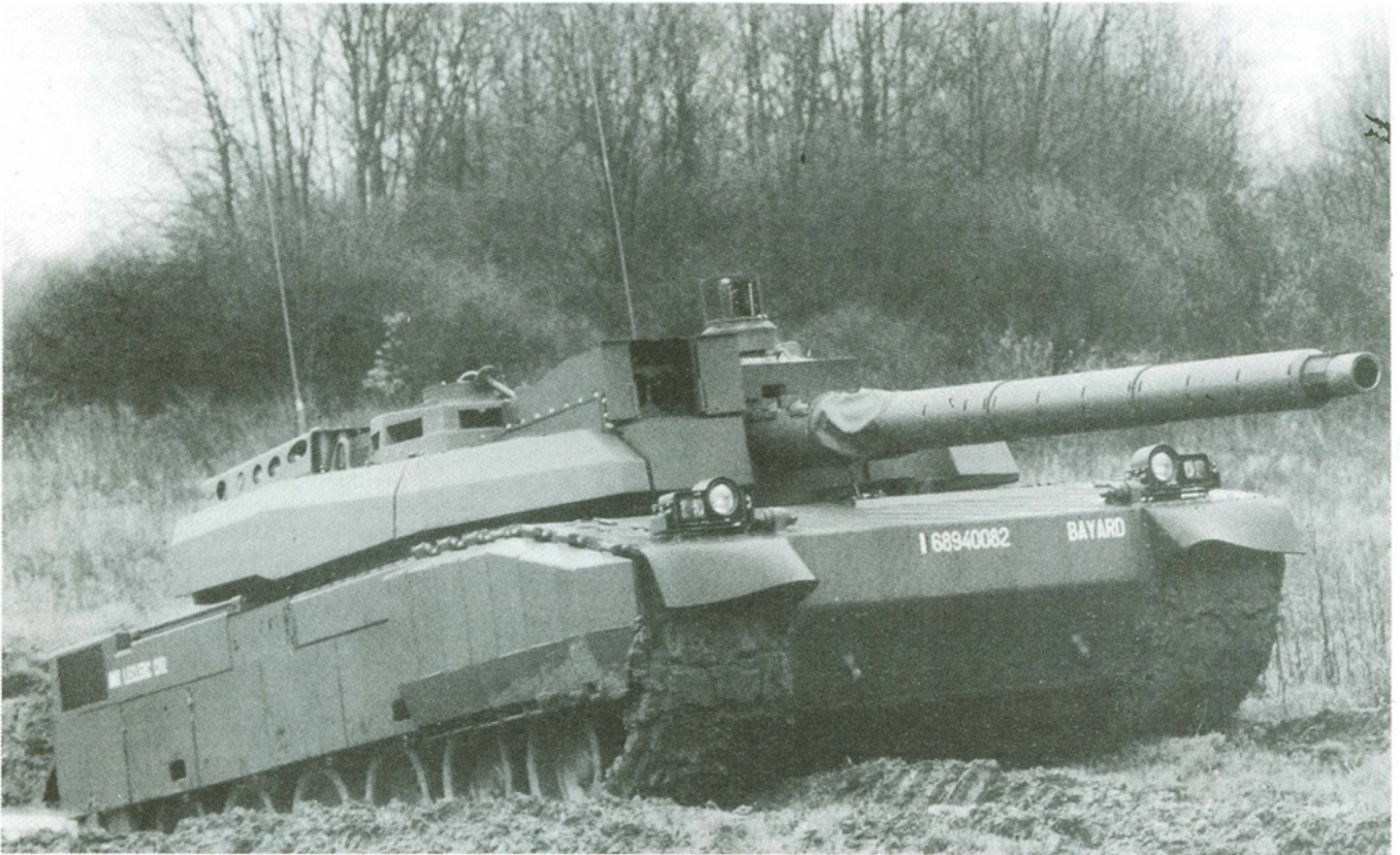
Het tweede prototype van de Leclerc, 'BAYARD' genoemd, tijdens een terreinbeproeving. Duidelijk blijkt het kleine frontoppervlak van de toren.
